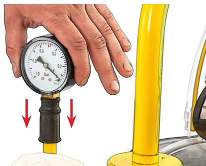
Collegare il bidone e l'apparecchio utilizzando il tubo del vuoto corto. Sul coperchio del bidone, collegare il tubo al raccordo dove è montata valvola del non ritorno.
