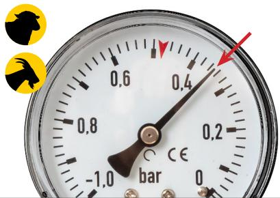
In entrambi i casi, assicurarsi che il livello di vuoto non superi i -0,5 bar! Se il livello di vuoto non è adeguato, è possibile regolarlo utilizzando il regolatore di vuoto montato sull'apparecchio.
