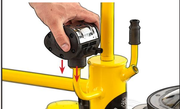
Csatlakoztassa a pulzátorhoz a fejő-egység(ek)ből érkező vékonyabb vákuumtömlőket.
