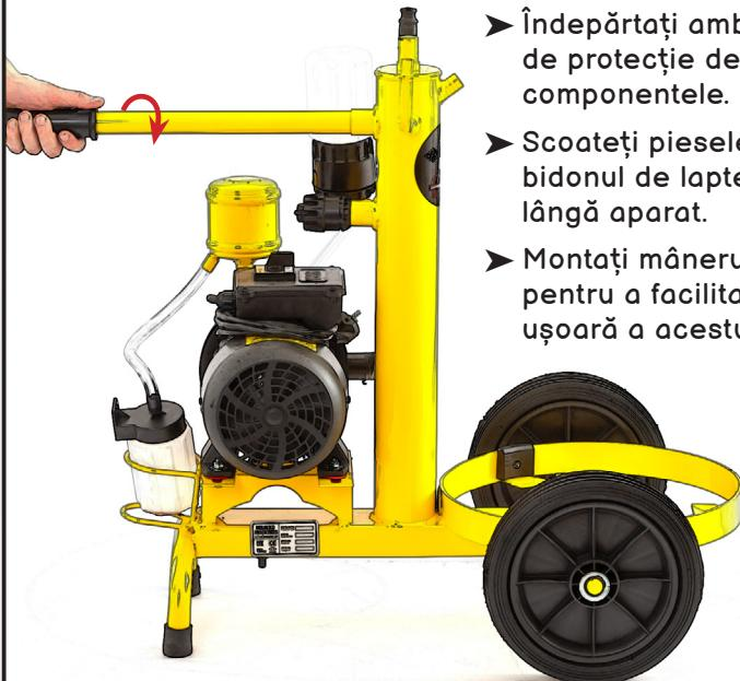
Se recomandă lucrul la o temperatură de peste 20 °C, pentru a facilita montarea furtunurilor. Dacă furtunurile sunt greu de montat, umeziți-le interiorul cu apă sau încălziți-le ușor capețele cu un pistol de aer Cald.
