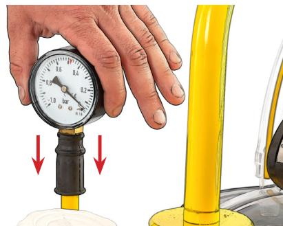
Kössé össze a sajtár és a gépet. A sajtár fedelén a tömlőt arra a bemenetre rögzítse, amelyen a labdás szelep található.
